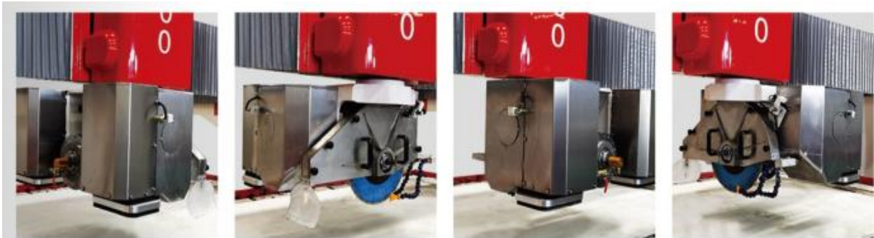
锯片可0°-90°倾斜, 0°-360°全自动旋转定位 Saw blade tilt 0°-90°, Rotation 0°-360° automatically.
